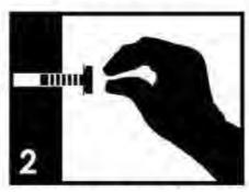
Positionnez correctment chacune des pièces et insérez les vis dans leurs orifices respectifs. Puis serrer à la main seulement jusqu'a 70 %. Resserrement complète avec les outils viendre à une étape ultérieure.
