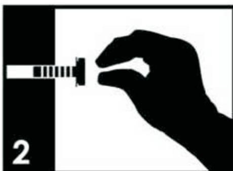
2 Positionnez correctement chacune des pièces et insérez les vis dans leurs orifices respectifs. Puis serrer à la main seulement jusqu'à 70 %. Resserrement complète avec les outils viendra à une étape ultérieure.
