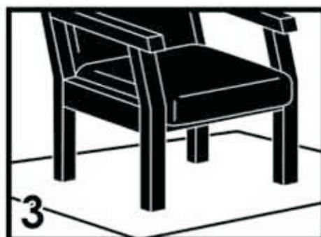
3 Assurez-vous que le meuble repose sur une surface plane et à niveau, que chaque pied touche au sol. Utilisez une couverture douce ou un tapis en dessous en tournant la pièce sur le côté.
