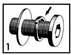
Avant de serrer chacune des vis, assurez-vous que la petite rondelle de blocage se trouve en la rondelle plus large et la tête de la vis.
